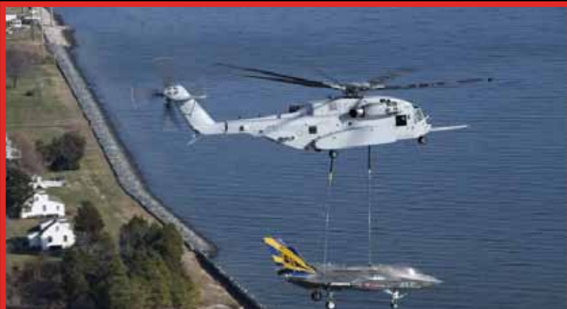
תיעוד מדהים: מסוק CH-53K הפועל ביחידת ההערכה והניסויים המבצעים של המארינס ביצע טיסת ניסוי לנשיאת משקל כבד בתצורה חיצונית, במהלכה חובר מטוס F-35C (ללא המנוע) באמצעות הוויים החיצוניים של המסוק והוא הונף והוטס על ידי המסוק. צילום: קירה הלויק, הצי האמריקאי
